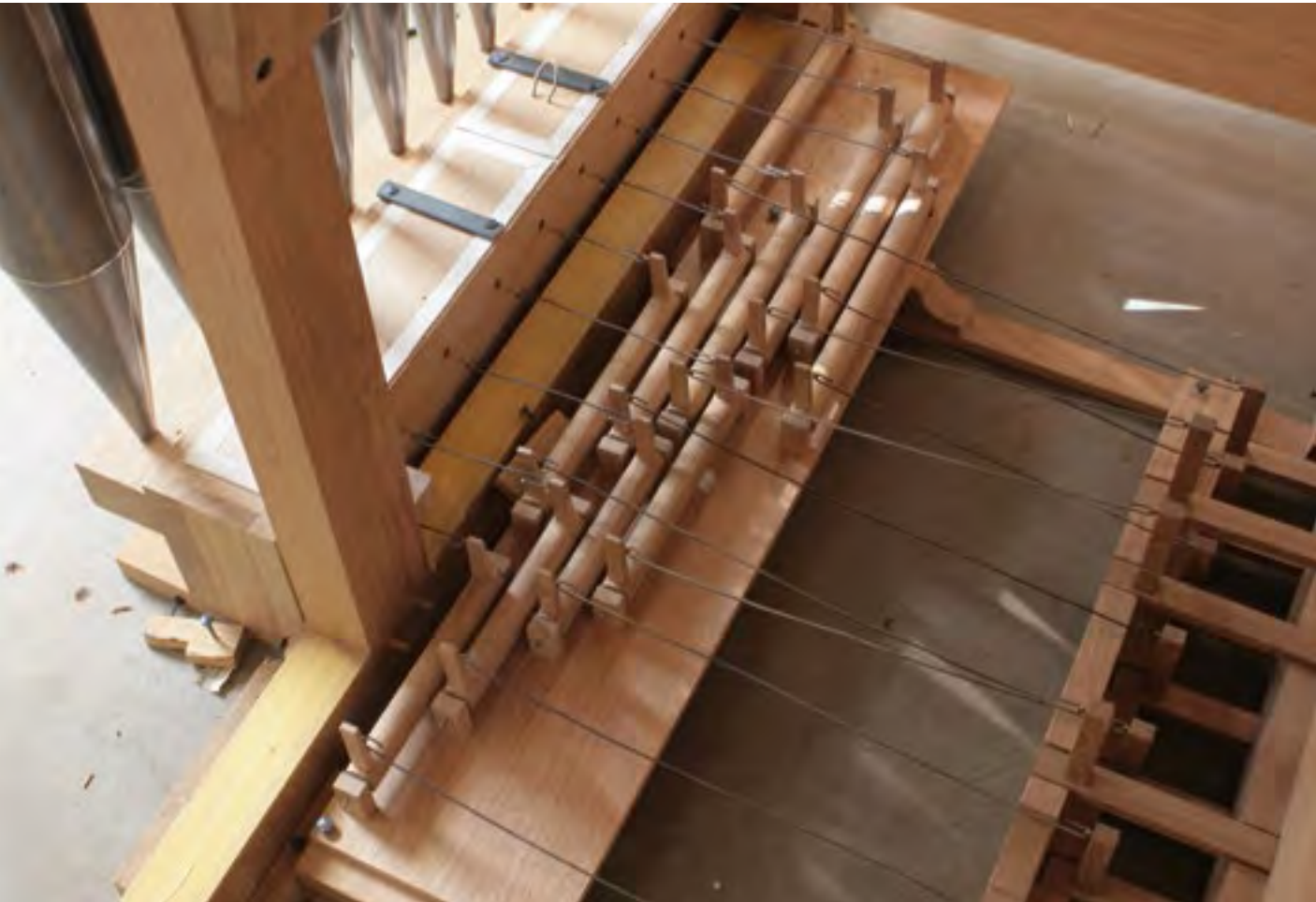
De foto's bij dit artikel zijn voornamelijk gemaakt in de werkplaats van Orgelmakerij Reil in Heerde, waar het nieuwe orgel van het Orgelpark gebouwd is. Te zien zijn op de kleine foto's achtereenvolgens één van de balgen, het gieten van platen metaal voor de orgelpijpen, een deel van het materiaal uit 1479 (bladzijde 18), de mechaniek tussen toetsen en pijpen (hierboven), en de ventielen. (bladzijde 24)
