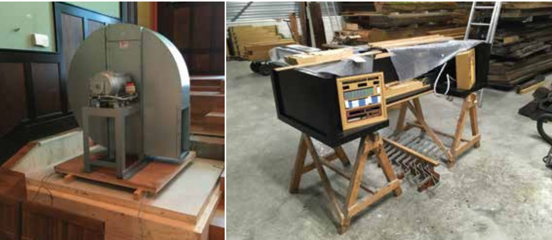
Twee foto's van de bouw van het nieuwe orgel in uitvoering: links de enorme windmotor (nu netjes aan het oog onttrokken met een dempkist, links naast het orgel), rechts de speeltafel in de werkplaats van Elbertse Orgelmakers
