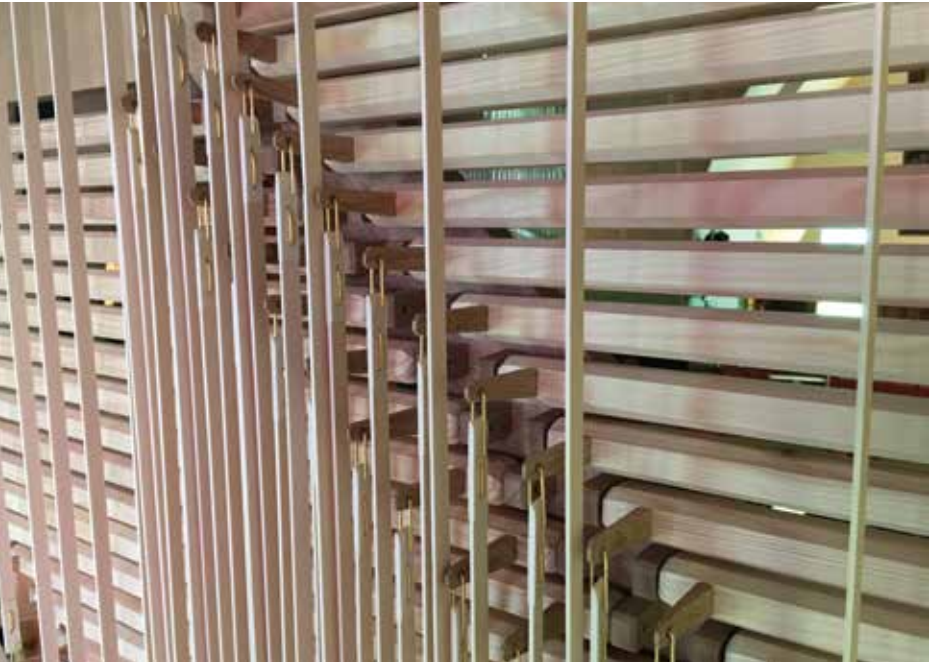
Detailfoto van de mechanische verbindingen tussen de toetsen en de windladen
